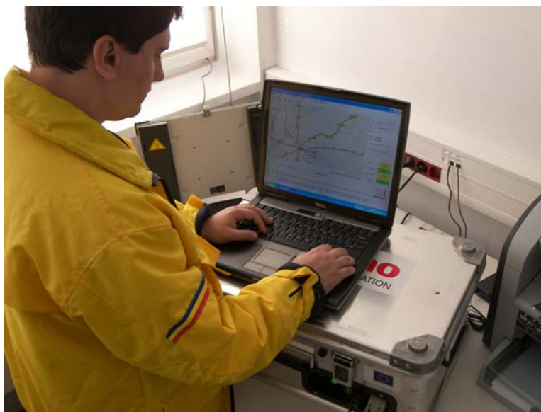
Fig. 8.1 Echipament portabil de detecție a radiațiilor cuplat cu sistem de poziționare GPS și transmisie GPRS a datelor
