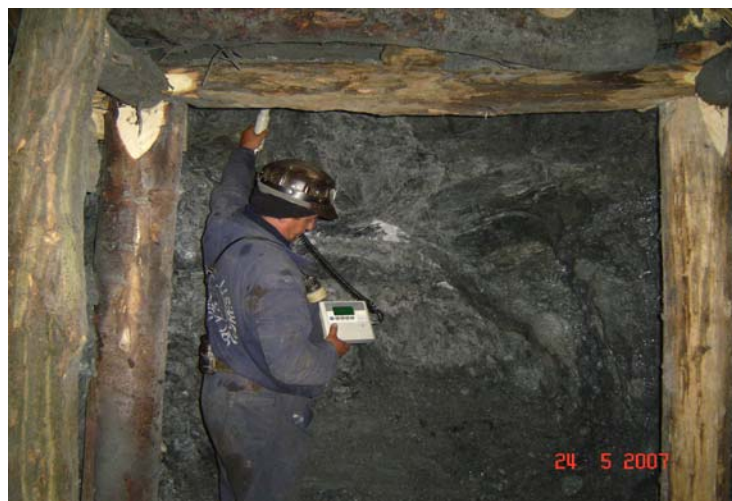
Fig. 6.13 Controlul activității de exploatare în subteran a minereului de uraniu – frontul de lucru al unei instalații de minerit -
