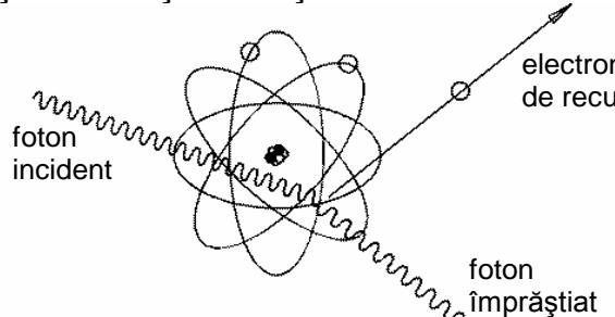
Cele trei tipuri principale de interacție a fotonilor cu materia - efect fotoelectric, efect Compton și formare de perechi - au probabilități de apariție diferite funcție de numărul atomic Z și energia fotonului incident. La energii mici și numere atomice mici (cum e cazul țesuturilor moi) predomină efectul fotoelectric, iar la energii mari, cu mult mai mari decât cele uzuale în radiologie, predomină formarea de perechi. Această comportare este ilustrată de figura următoare.
