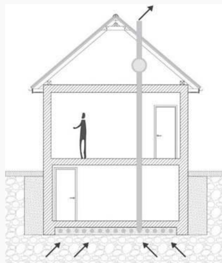
Figura 44 - Schema de principiu - Scăderea presiunii sub structura de contact prin ventilare naturală sau mecanică
