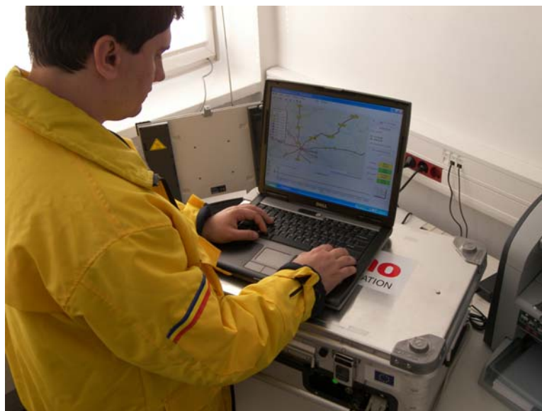
Fig. 8.1 Echipament portabil de detecție a radiațiilor cuplat cu sistem de poziționare GPS și transmisie GPRS a datelor
