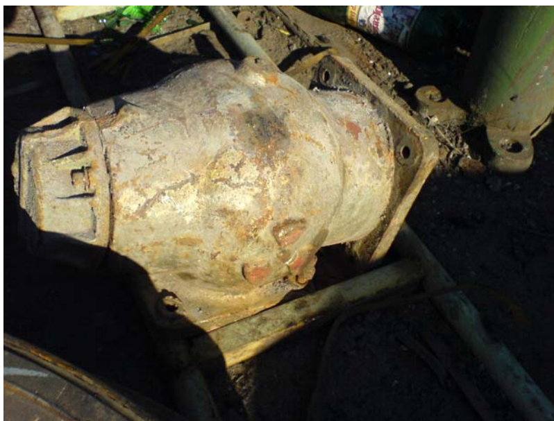
Fig.3.16 Sursă radioactivă orfană în castel de plumb, marcată cu semnul « radioactiv », găsită în depozitul de fier vechi al REMAT SUD București
