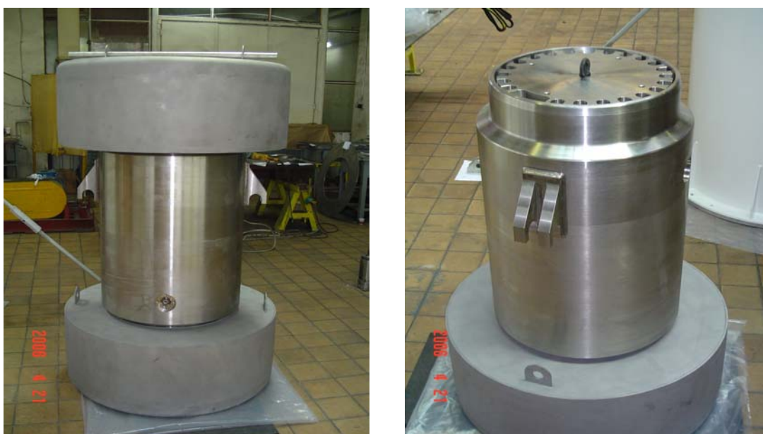
Fig. 3.6 Containerul de tip B(U) destinat transportului de elemente combustibile iradiate de tip CANDU de la Cernavodă la SCN Pitești.
